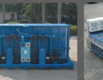
轮胎生产线大型冷却装置
