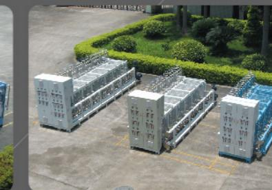
轮胎生产线温控总成
